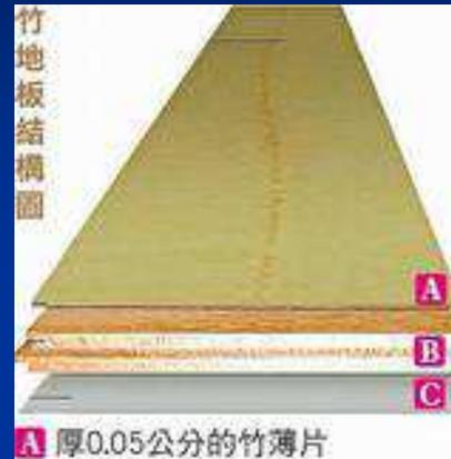
改良後的薄片化竹地板，是將竹子切成薄片，以仿海島型木地板的做法，在木夾板上，鋪上薄竹片，藉此降低竹子的醣份與澱粉質，同時一併解決熱漲冷縮過大的問題。也因竹薄片地板不易熱脹冷縮，鋪置時即不需留縫，可減少藏污納垢。竹子本身質地很堅韌，加上地板表面會上保護漆，正常使用可使用很久，達30幾年。
